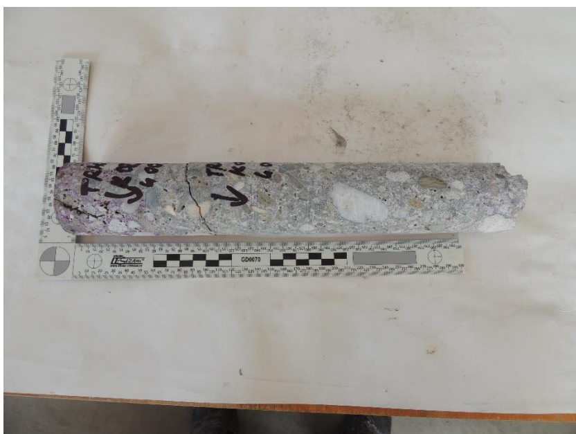
Fotodokumentace provedeného vývrtu přes trhlinu v klenbě K02
